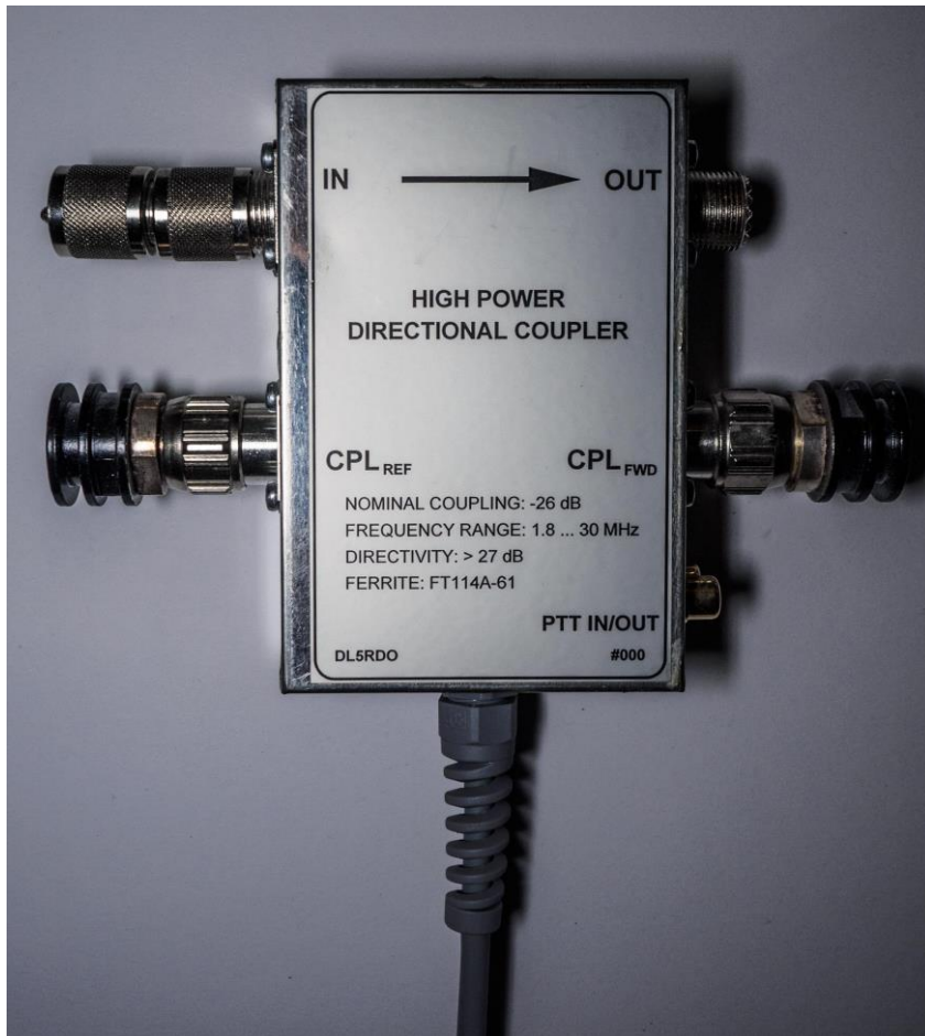
Bild 7: Außenansicht des Richtkopplers (DL5RDO Version)
